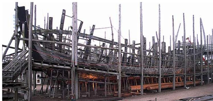
**Fig. 3. The "7 Provinciën" under construction**
