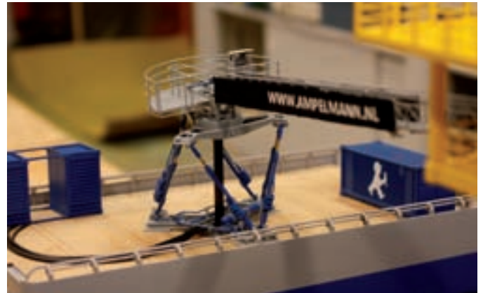
Figuur 11. Dynamisch schaalmodel van de Ampelmann
