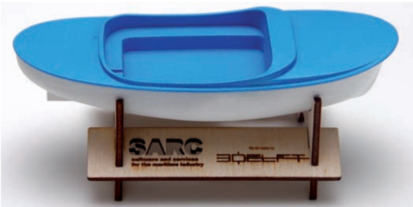
Figuur 9. De sloep geproduceerd met Selective Laser Sintering (SLS)
