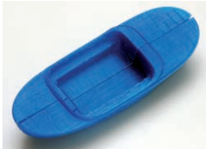
Figuur 5. SB- en BB-delen van de sloep geprint met de Ultimaker en vervolgens verlijmd
